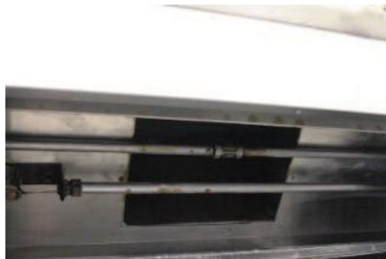
Nelle foto soprastanti un esempio fornito dal produttore di lampade di un sistema VUV utilizzato nella cappa di una friggitrice in una cucina professionale, sinistra prima, a destra dopo 3000 ore di funzionamento VUV.
